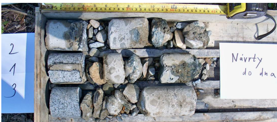
Obr. č. 3 – diagnostické návrtý do dna
